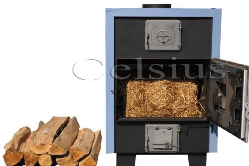
CBE sono caldaie a tiraggio naturale adatte ad essere alimentate a tronchi di legna lunghi fino ad 1mt. Sono realizzate in acciaio corten secondo la recente normativa EN 303-5, vano legna molto profondo e passaggi fumi nella parte superiore. CBE è la caldaia adatta a contesti rurali dove sono presenti biomasse come legna di varie lunghezze, fascine, piccole balle di paglia.
